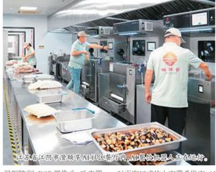
温探阵列、RGB摄像头、功率器 件和气味传感器等工具,细致捕 捉每一道菜在烹饪过程中的温 度、颜色变化以及气味等多维度
