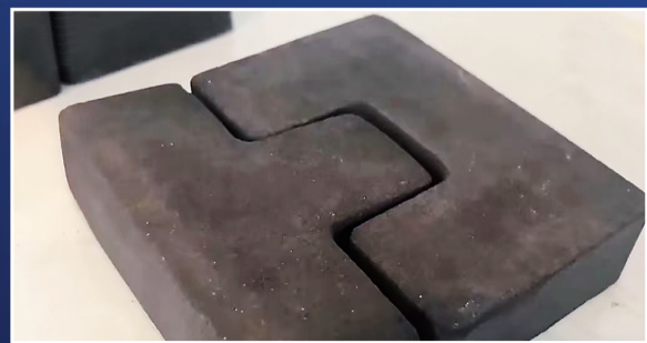
两块成形的模拟“月壤砖”呈现的是榫卯结构。
