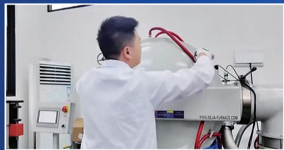
“月壤砖”在真空装置中需加热到1000℃以上。
