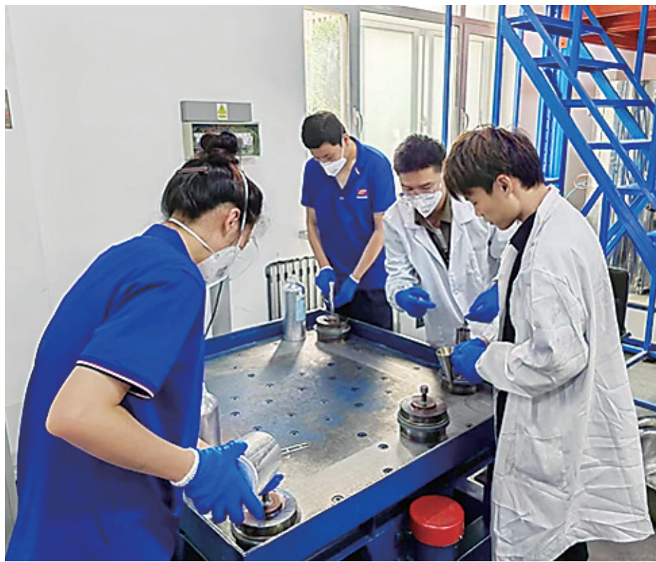
中国科学院金属研究所航空发动机钛合金研发团队在进行发动机配件粉末填充铸造。徐磊供图
