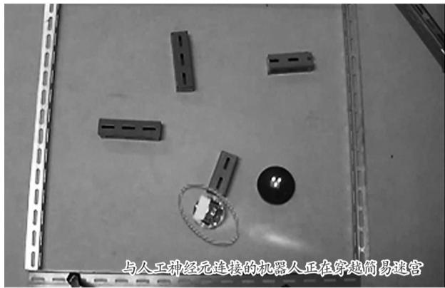
与人工神经元连接的机器人正在穿越简易迷宫
