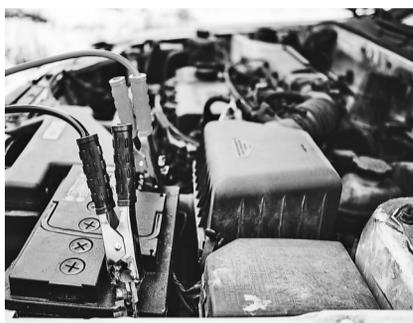
在3秒钟,若第一次发动机启动失败,建议间隔15秒后再次打火,否则蓄电池频繁向启动机提供强大电流,会造成其自身的损耗。
