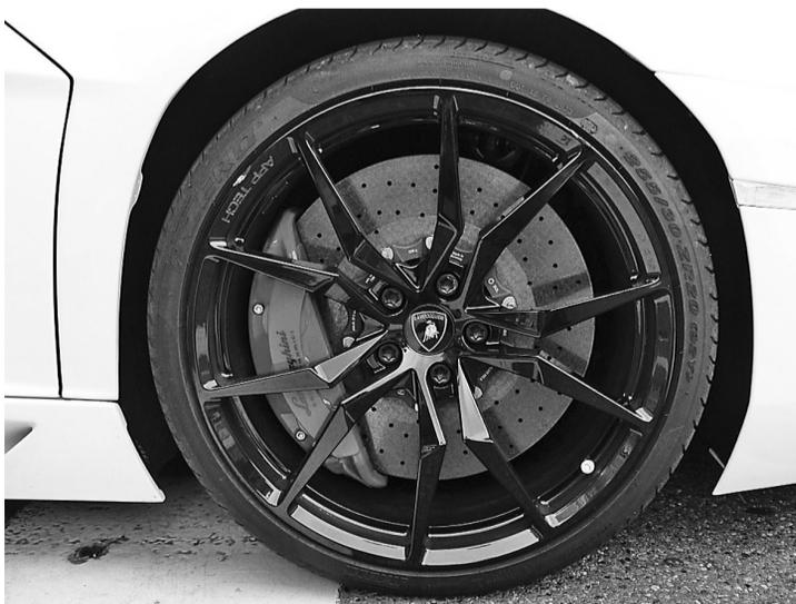
**1. 方向盘偏转** 在踩下刹车时,方向盘会向一侧有偏转的趋势,我们俗称“偏刹”。汽车在正常行驶过程中,刹车盘的转动速度很快,分泵作用不均匀会导致方向盘有偏转的趋势,所以发现这种情况最好及时检查。
